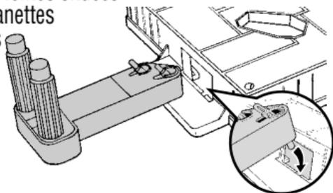
2. Insérer les socles des robots dans les trous sur le plancher de l'arène et les emboîter sur les manettes.
