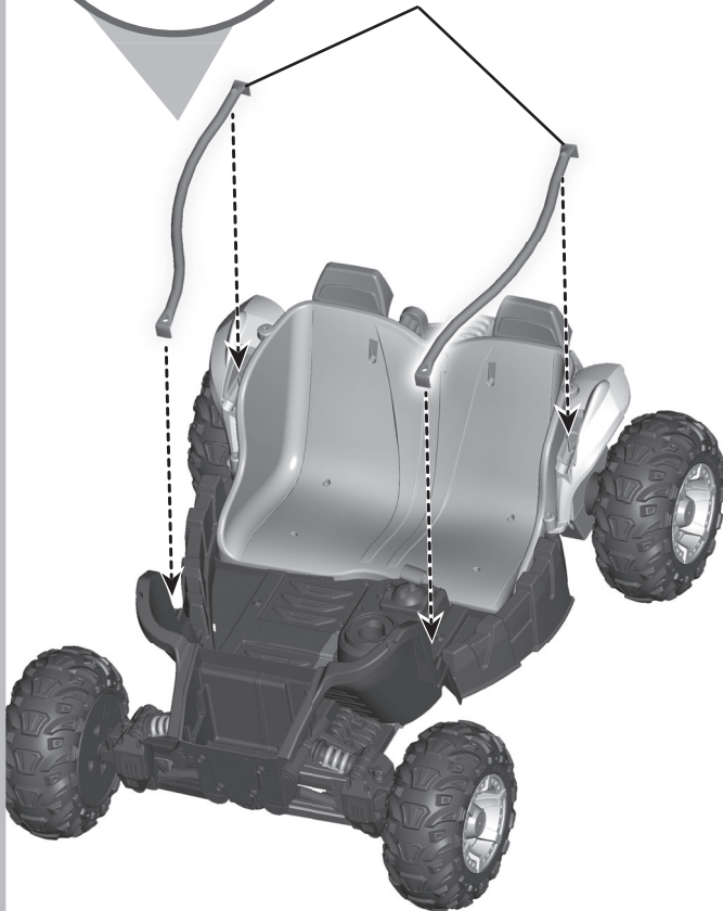
Sidebar with Curve Out Barra lateral con curva hacia afuera Barre latérale courbée vers l'extérieur
