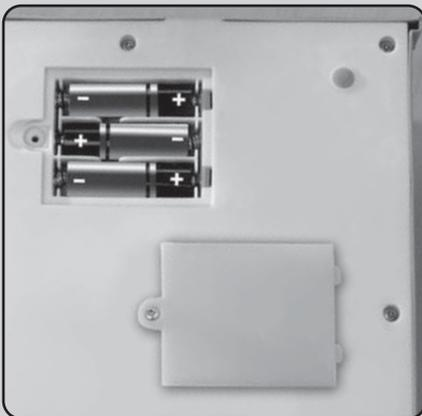
Destornillar la tapa del compartimiento de pilas de la parte de abajo del juego con un destornillador de estrella (no incluido) y retirarla.
